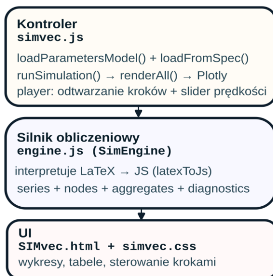
Rys 7.3 Architektura warstwowa aplikacji SIMVEC
